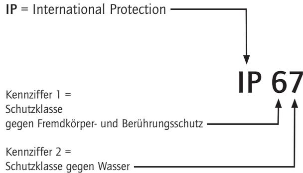
Aus Sicherheitsgründen müssen Steckverbinder gegen Einflüsse von außen, wie z.B. Staub, Fremdkörper, Berührung, Feuchtigkeit und Wasser geschützt werden. Diesen Schutz übernehmen bei Industrie-Steckverbindern die Gehäuse mit ihrer Verriegelung und dem abgedichteten Kabeleingang. Die Schutzarten werden auch IP-Codes genannt. Die Abkürzung IP steht für „Ingress Protection“ (dt. Schutz gegen Eindringen). In der Norm IEC 60529 sind die Schutzgrade festgelegt und in verschiedene Klassen eingeteilt.
